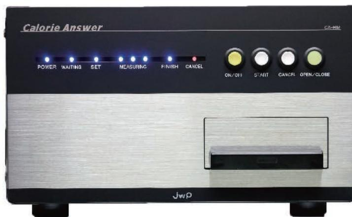
カロリーアンサーは、近赤外線分光分析法の採用により、液体サンプルは「透過測定方式」、粉体・固形サンプルは「反射測定方式」にて、測定物のカロリーの他に、参考値として、タンパク質、脂質、炭水化物、水分などの栄養成分の測定が可能な装置です。
